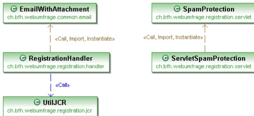
Abbildung 19: Klassendiagramm ch.bfh.webumfrage.registration
